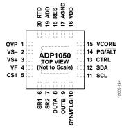
NOTES 1. THE ADP1050 HAS AN EXPOSED THERMAL PAD ON THE UNDERSIDE OF THE PACKAGE. FOR INCREASED RELIABILITY OF THE SOLDER JOINTS AND MAXIMUM THERMAL CAPABILITY, IT IS RECOMMENDED THAT THE EXPOSED PAD BE SOLDERED TO THE PCB AGND PLANE.
