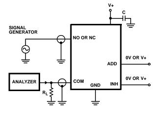
FIGURE 4. OFF-ISOLATION TEST CIRCUIT
