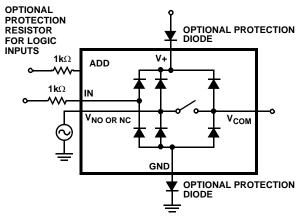
FIGURE 8. OVERVOLTAGE PROTECTION
