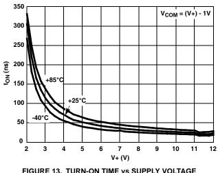
FIGURE 13. TURN-ON TIME vs SUPPLY VOLTAGE
