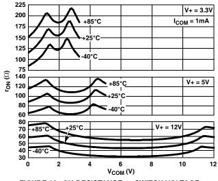
FIGURE 10. ON-RESISTANCE vs SWITCH VOLTAGE
