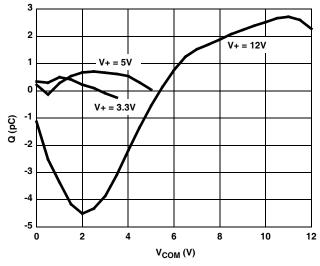
FIGURE 16. CHARGE INJECTION vs SWITCH VOLTAGE
