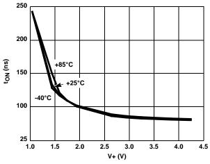
FIGURE 17. TURN-ON TIME vs SUPPLY VOLTAGE
