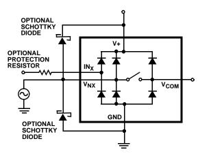
FIGURE 9. OVERVOLTAGE PROTECTION
