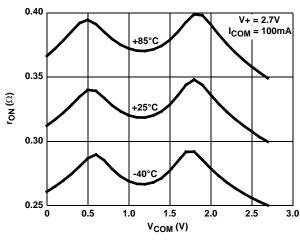
FIGURE 13. ON-RESISTANCE vs SWITCH VOLTAGE
