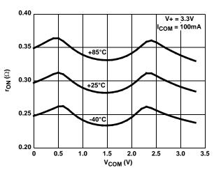
FIGURE 12. ON-RESISTANCE vs SWITCH VOLTAGE
