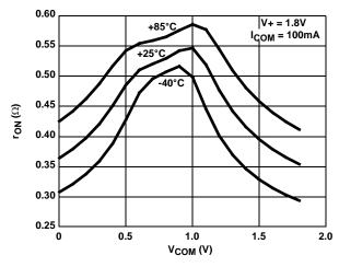
FIGURE 14. ON-RESISTANCE vs SWITCH VOLTAGE
