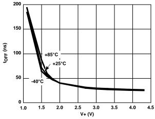
FIGURE 16. TURN-OFF TIME vs SUPPLY VOLTAGE
