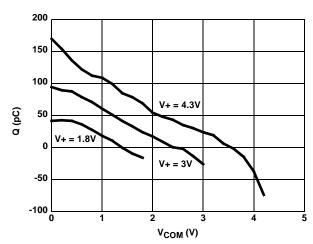
FIGURE 15. CHARGE INJECTION vs SWITCH VOLTAGE
