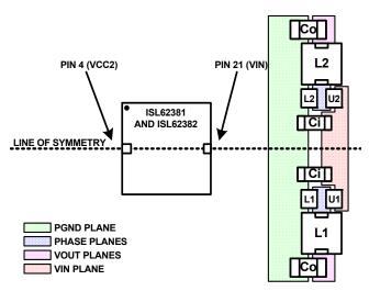
FIGURE 30. SYMMETRIC LAYOUT GUIDE
