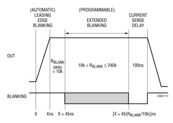
Figure 12. Leading Edge Blank Timing
