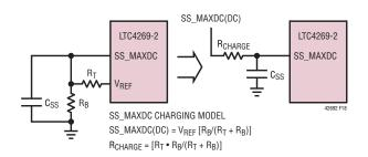
Figure 18. Programming Soft-Start Timing
