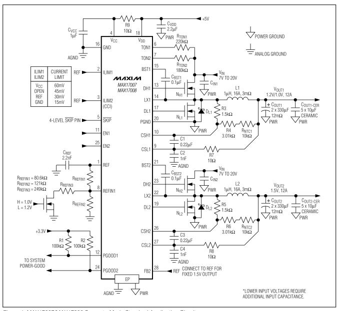
Figure 1. MAX17007/MAX17008 Separate-Mode Standard Application Circuit
