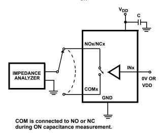
FIGURE 3. CAPACITANCE TEST CIRCUIT
