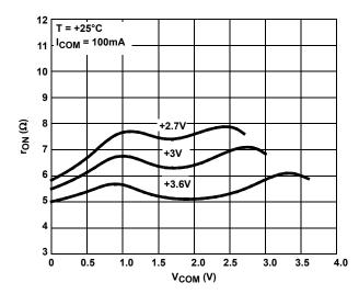
FIGURE 14. ON-RESISTANCE vs SWITCH VOLTAGE; COM1B AND COM4B
