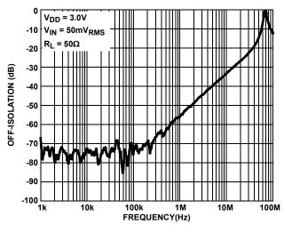
FIGURE 18. OFF-ISOLATION; COM1A AND COM4A
