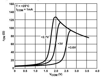
FIGURE 10. ON-RESISTANCE vs SWITCH VOLTAGE; COM2x AND COM3x
