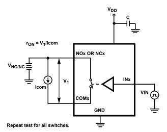
FIGURE 1.  $r_{ON}$  TEST CIRCUIT
