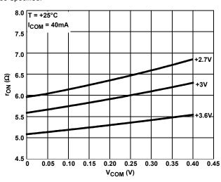
FIGURE 8. ON- RESISTANCE vs SWITCH VOLTAGE; COM2, COM3
