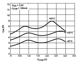
FIGURE 13. ON-RESISTANCE vs SWITCH VOLTAGE; COM1B AND COM4B
