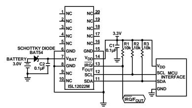
FIGURE 1. TYPICAL APPLICATION CIRCUIT
