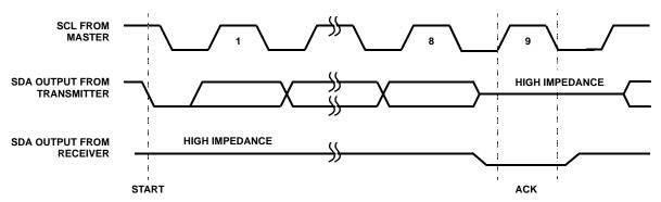
FIGURE 18. ACKNOWLEDGE RESPONSE FROM RECEIVER
