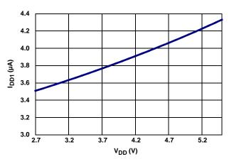
FIGURE 7.  $I_{DD1}$  vs  $V_{DD}$
