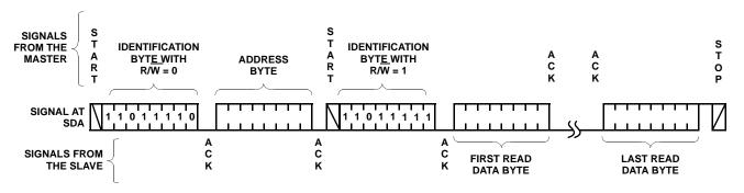
FIGURE 21. READ SEQUENCE (CSR SLAVE ADDRESS SHOWN)
