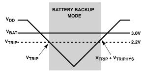
FIGURE 15. BATTERY SWITCHOVER WHEN  $V_{BAT} > V_{TRIP}$
