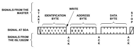
FIGURE 19. BYTE WRITE SEQUENCE (SLAVE ADDRESS FOR CSR SHOWN)
