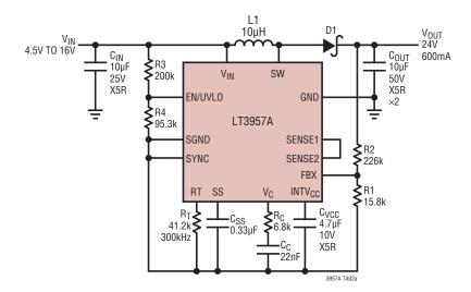
C<sub>IN</sub>: MURATA GRM31ER61H106KA12 C<sub>OUT</sub>: TAIYO YUDEN UMK325BJ106MM D1: VISHAY SILICONIX 10BQ040 L1: VISHAY SILICONIX IHLP-5050CE-1
